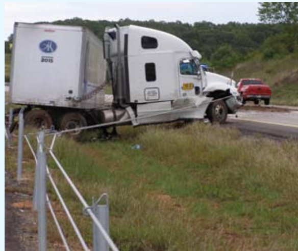
Bekaert en Gibraltar werkten samen voor de kabelafsluiting die een K-12 rating kreeg. De afsluiting stopt een LB truck van 15 000 lb die er frontaal op inrijdt aan 80 km/u.
